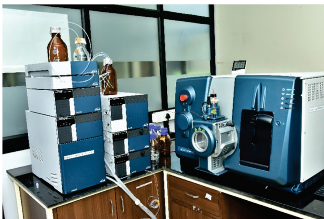
चित्र 2: ईएसआई-मास स्पेक्ट्रोमीटर (एससीआईईएक्स क्यूटीआरएपी® एलसीएमएस / एमएस 6500 +) यहाँ दिखाया गया है।
